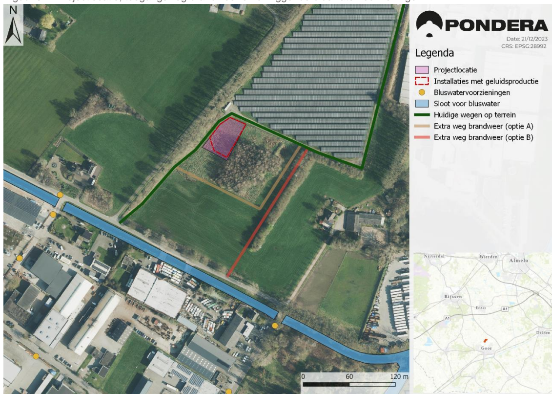
Figuur 5.4. Projectlocatie, toegangsweg brandweer en omliggende bluswatervoorzieningen
