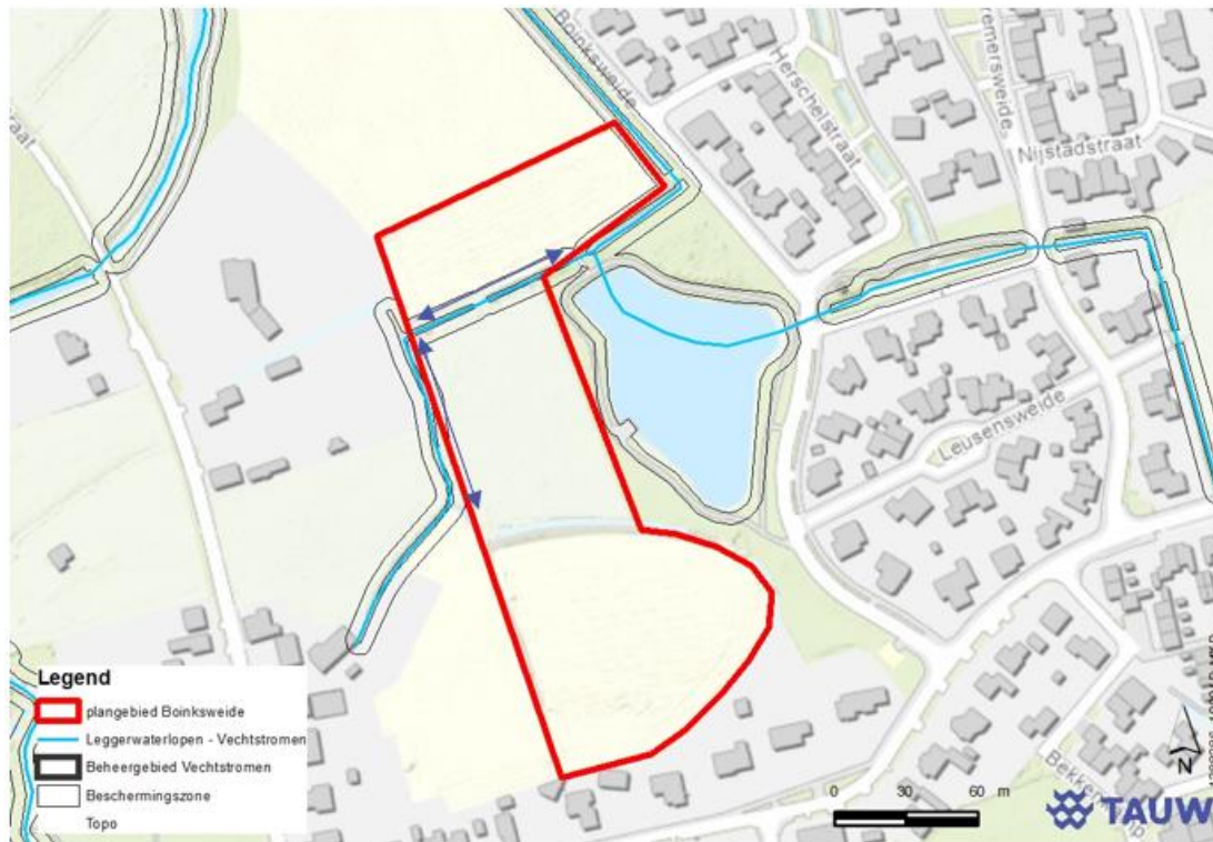
Figuur 2.16 Leggerkaart, beschermingszone oppervlaktewater. (↔) Zijde watergang waar onderhoud plaatsvindt
