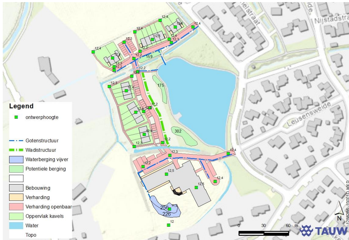
Figuur 3.8 Ontwerptekening met ontwerppeilen en afvoerrichting op hoofdlijnen
